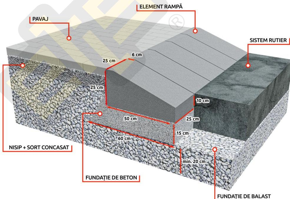
Elementele de rampă se montează conform cotelor și aliniamentelor date în proiect, pe o fundație de beton C16/20, turnată semiuscat și așezată pe infrastructura compactată a obiectivului (drum, platformă).
