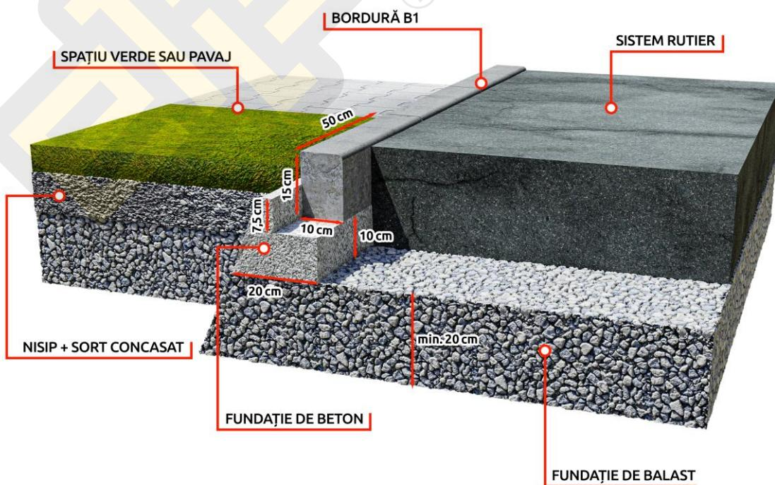
Bordurile se montează conform cotelor și aliniamentelor date în proiect, pe o fundație de beton C12/15, cu secțiunea de minim 10x20 cm, pozată semiuscat și așezată pe infrastructura compactată a obiectivului (drum, platformă).
